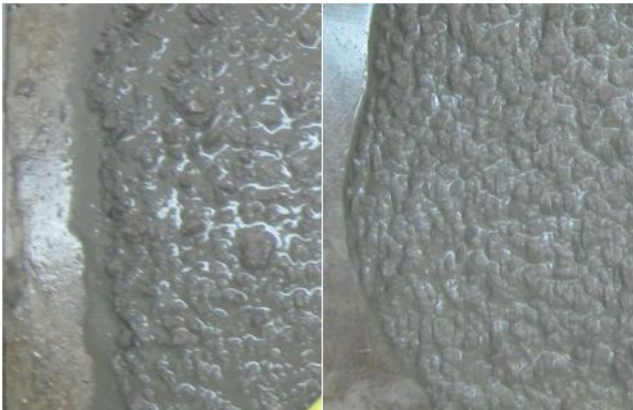
Figura 1. Comparativa del aspecto de concretos autoconsolidables. A la derecha un concreto con una sustitución al 10% de micro sílice, a la izquierda un concreto elaborado con una sustitución de nano sílice al 1.5%. Se aprecia que la nano-sílice evita la segregación de los materiales.
