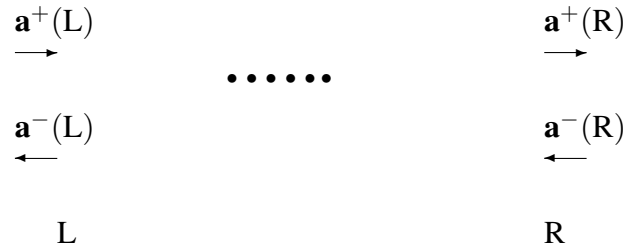
Fig. 3 Esquema de scattering. Entre L y R puede haber una simple intercara -L y R empalmados directamente- o cualquier estructura intermedia.
