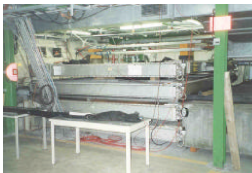
Figura 1. La última versión del diseño experimental en el área de UA2, en esta fotografía sólo se puede apreciar un plástico centellador que sirvió de disparo, está sobre la mesa, los otros dos están en el techo, arriba del experimento.
