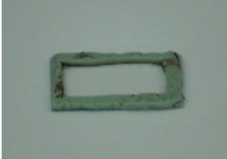
Figura 3.18: Celda para la observación óptica de la estructura en un fluido MR.
