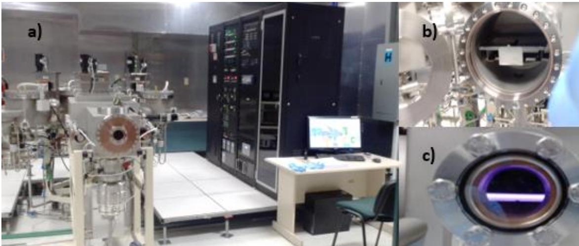
Figura 3.8: a) Sistema RF-PECVD (13.56 MHz), b) Se fija soporte de muestras en la cámara y c) Proceso de depósito por medio de plasma.
