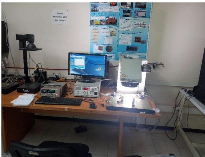
Figura 3.5: a) Simulador solar ORIEL SOL 2 con un espectro estándar AM 1.5.
