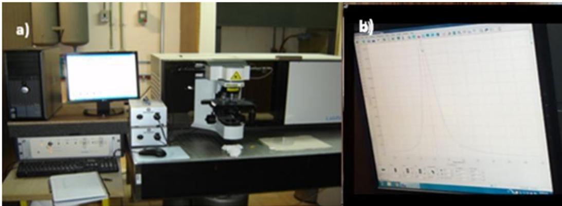
Figura 3.2: a) Equipo Raman, b) Obtención de Espectro.
