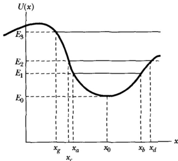
El movimiento con  $E_1$  en  $x_a \leq x \leq x_b$  puede ser analizado mediante la **aproximación armónica**,
