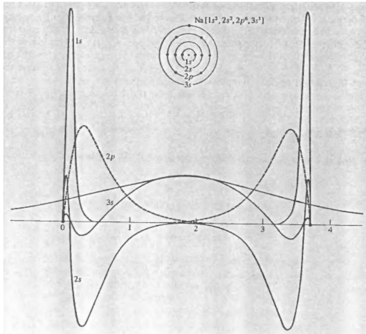
El método de enlace fuerte, o **tight-binding**, consiste en expandir los estados de un cristal en combinaciones lineales de orbitales atómicos (LCAO) de los átomos que lo conforman.
